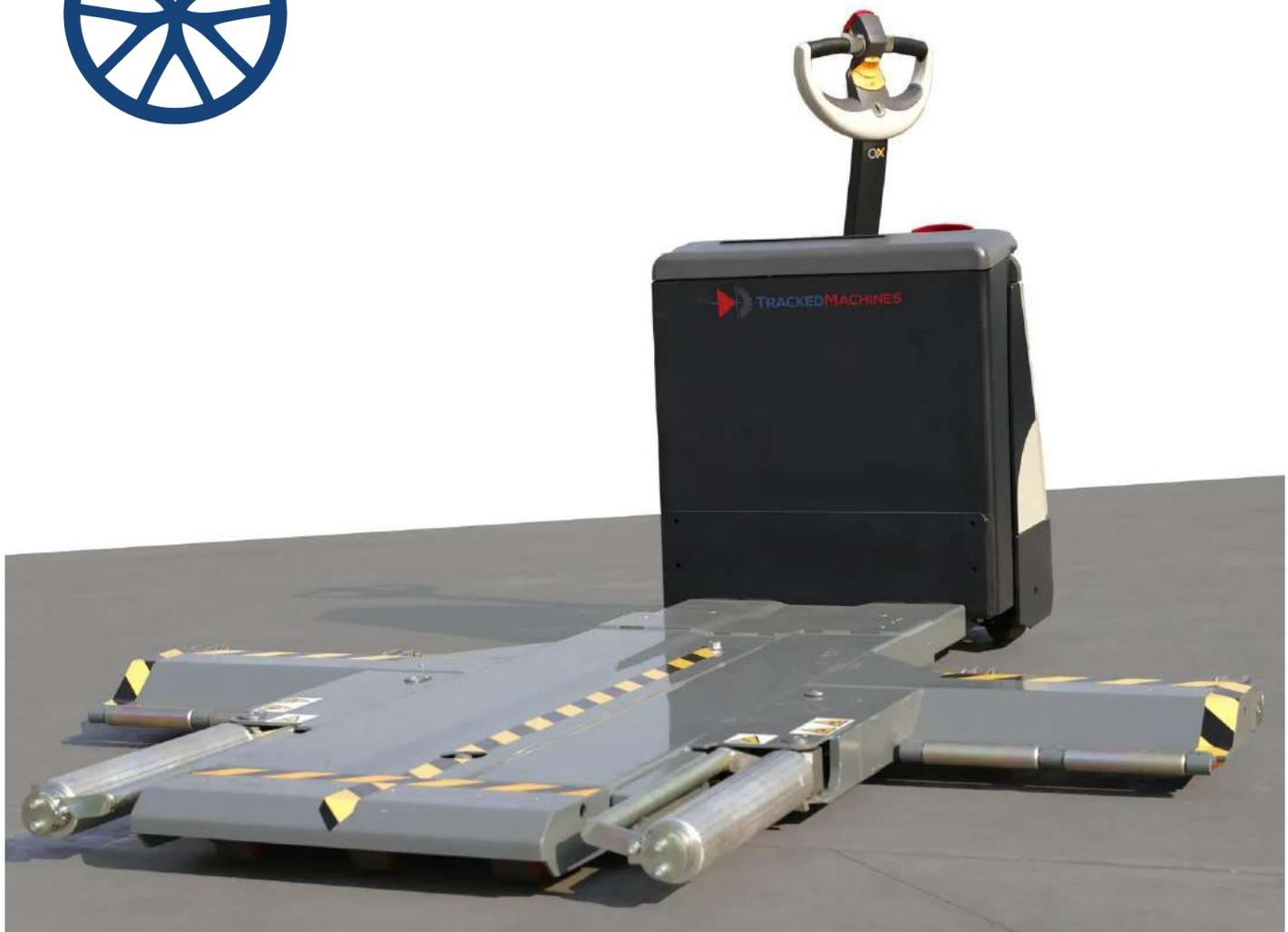
Der CARMOVER ist ein unverzichtbares Werkzeug zum Bewegen von Fahrzeugen bis zu 4t Eigengewicht und mit einem Radstand von bis zu 3 m.
